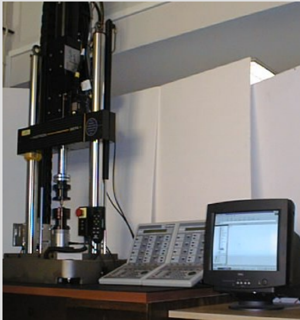
Máquina Fadiga Multiaxial
