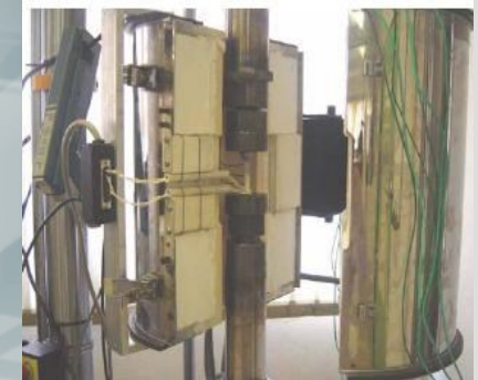
Equipamento de ensaios fluência-fadiga a alta temperatura
